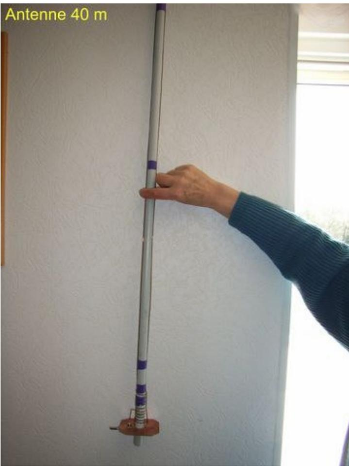
à l'aide d'un tube électrique (tube IRO de 20mm).
